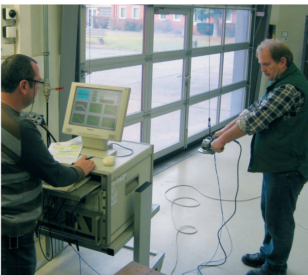
Bild 2 und 3: Messung der Hand-Arm-Schwingung an der Klauenpflegescheibe
